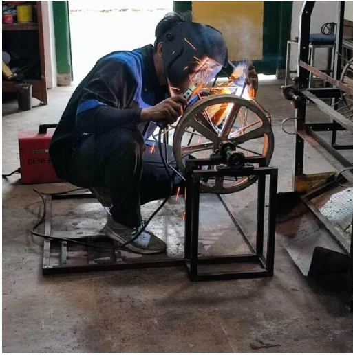
Gambar 4. Proses pembuatan alat pemintal pelepah pisang
